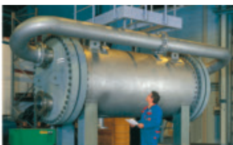
30 МВт экономайзер сточных вод на этиленоксидном заводе, тип PSHE 14НН-968/2/2
