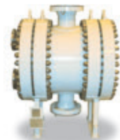
2-ступенчатый всасывающий охладитель (бессернистый природный газ) 2132 кВт, тип 7НН-256/1/1 с титановыми пластинами и корпусом из Duplex, 55-барная конструкция, работает на платформе по производству газа.
