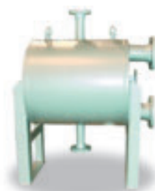
187 кВт, теплообменник триэтиленгликоль - насыщенный триэтиленгликоль, тип 5НН-220/1/1, корпус из Duplex, работает на платформе по производству газа.
