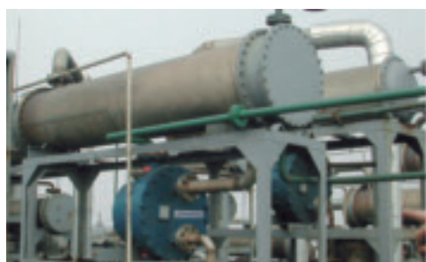
660 кВт конденсатор бензола, тип PSHE 5НН-126/1/1
