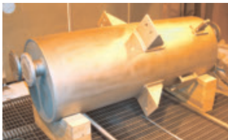
5500 кВт частичный испаритель бензина на нефтеперерабатывающем заводе, тип PSHE 5НН-544/4/4
